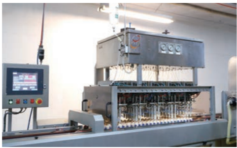
卵の段階でワクチンを接種できる卵内接種機
